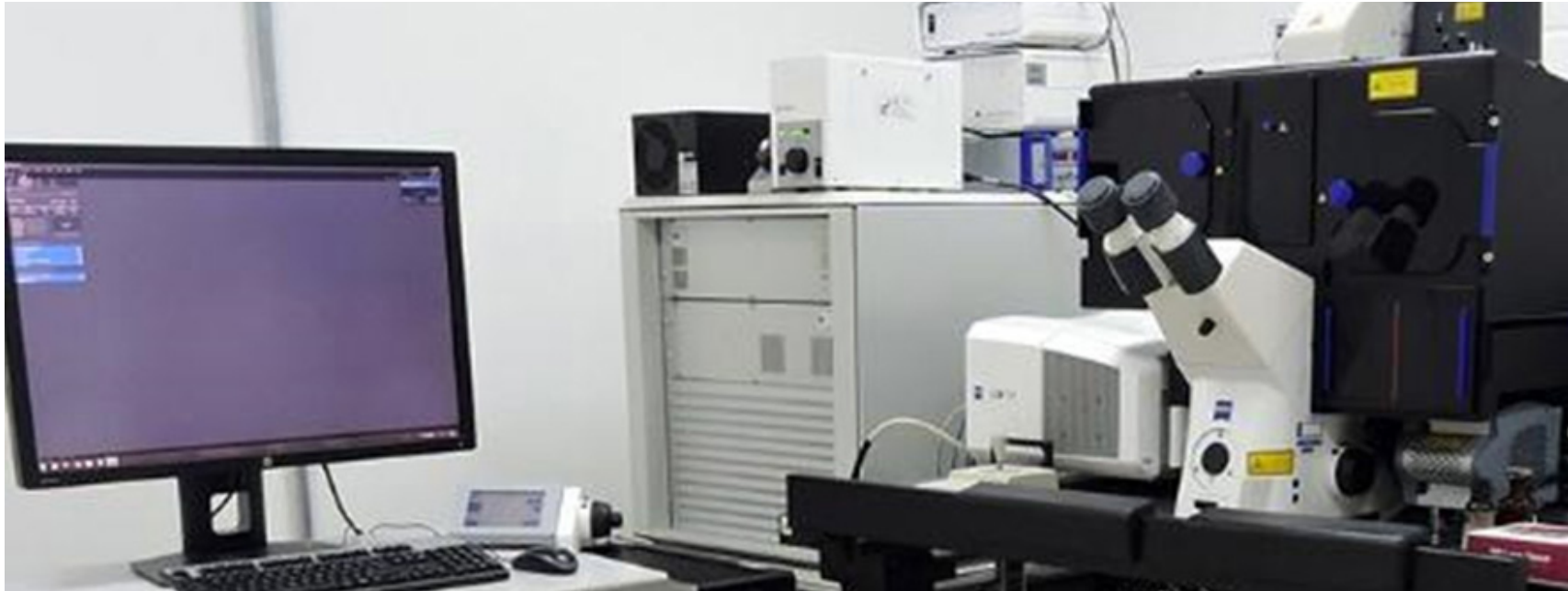
Microscópio óptico de superresolução ZEISS Elyra PS1. / ZEISS Elyra PS1 Super Resolution Optical Microscope.
