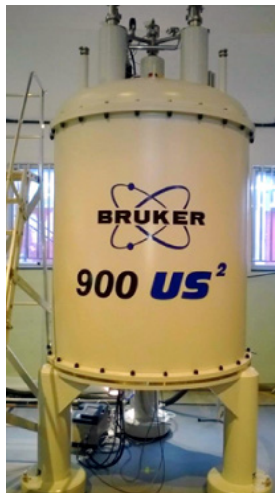
Espectrômetro de 900 MHz, único na América Latina, instalado no CENABIO. Crédito: Arquivo CENABIO. / 900 MHz spectrometer, unique in Latin America, installed at CENABIO. Credit: CENABIO archive.
