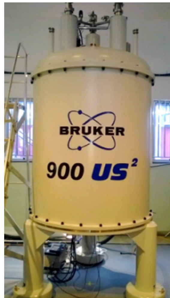
Espectrômetro de 900 MHz, único na América Latina, instalado no CENABIO. Crédito: Arquivo CENABIO. / 900 MHz spectrometer, unique in Latin America, installed at CENABIO. Credit: CENABIO archive.
